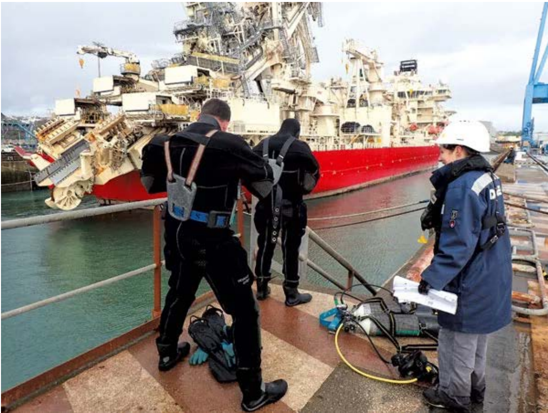
Mesurant 194 mètres de long pour 31 mètres de large, le Deep Energy , fleuron de la flotte de TechnipFMC, est un des plus gros navires de pose de conduites sous-marines. Doté d'un système de positionnement dynamique, il peut opérer jusqu'à 3 000 mètres de fond. Des plongeurs interviennent dans la forme de radoub pour contrôler qu'il va se placer correctement sur ses tins. © Sandrine Pierrefeu
