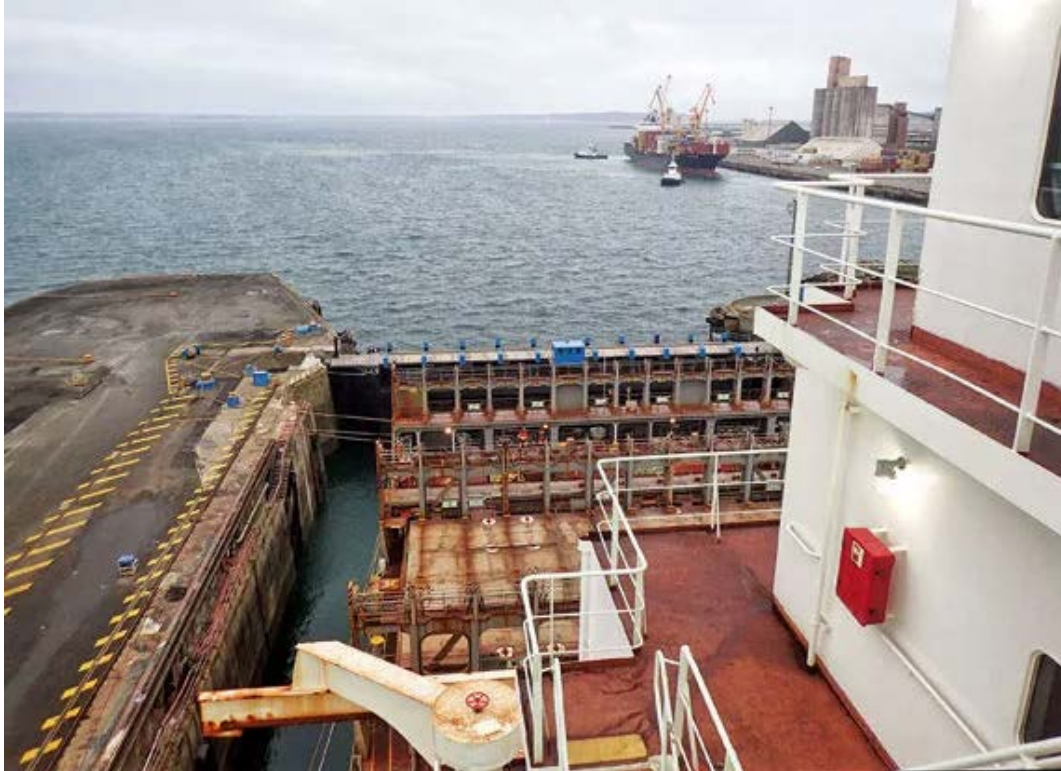
Le YM Evolution est entré dans la forme numéro 2, fermée par un bateau-porte. Pendant plusieurs heures, le navire va être constamment repositionné, pendant que l'eau est pompée dans la forme. © Sandrine Pierrefeu
